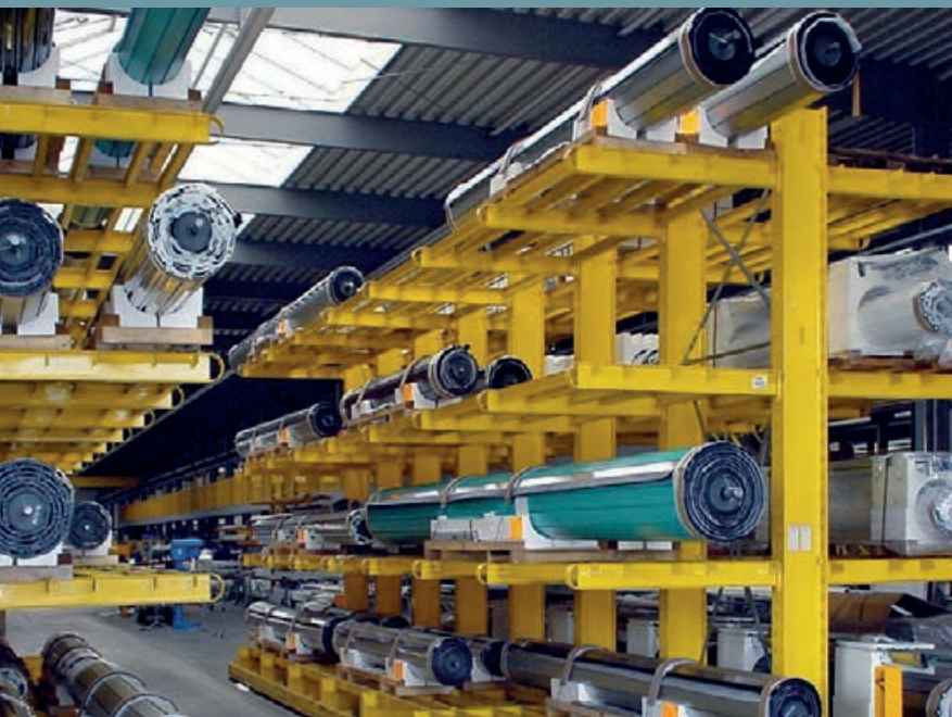
Hotové roletové dveře v robustních konzolových regálech. Rámové můstky mezi rameny pro skladování různých rozměrů.
