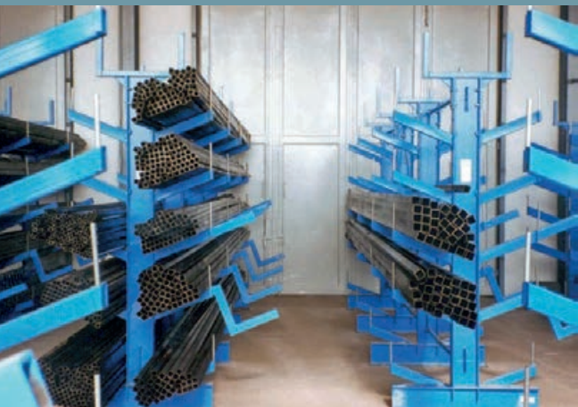
Regály se šikmými rameny pro skladování jeřábem. Manipulace pomocí komisi rychlospojky s trnem nebo rychlospojky s trnem pro skladování.
