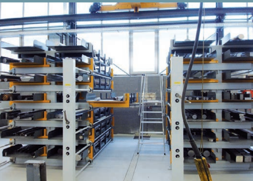
U teleskopických konzolových regálů se všechny úložné roviny vysouvají pomocí kliky přes otočná vřetena. Optimální pro manipulaci jeřábem při minimální šířce uličky.
