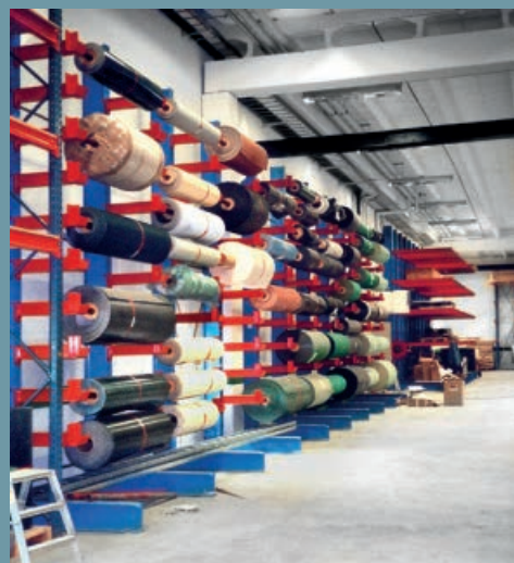
Konzolové regály se speciálním uchycením na skladování válců.
