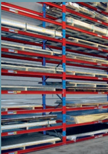
Paletové regály pro skladování tabulí z plexiskla
