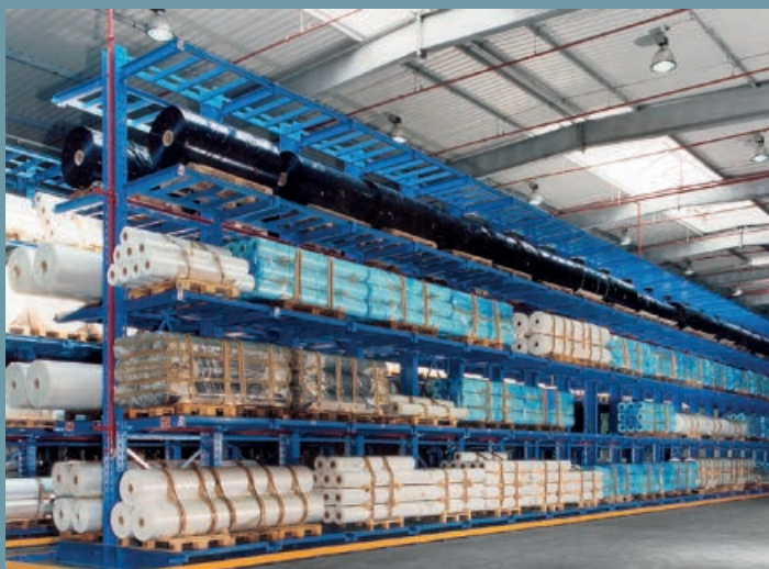
Konzolové regály s ramenovými můstky pro skladování těžkých plastových fólií.
