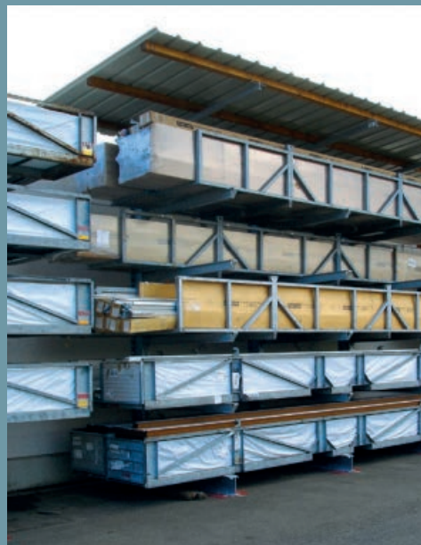
Plastové profily uložené v kazetách s ochranou proti povětrnosti.
