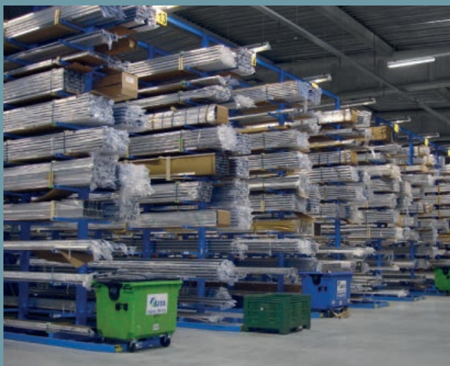
Systém s úzkými uličkami s můstky pro sklad hliníkových profilů.
