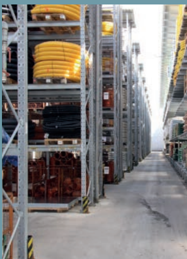
Paletové regály pro skladování plastových hadic
