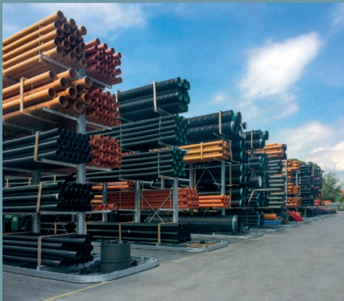
Venkovní skladování plastových trubek ve velkoobchodě. Žárově zinkované konzolové regály s vodicími kolejnicemi pro 4cestné vysokozdvíže vozíky.
