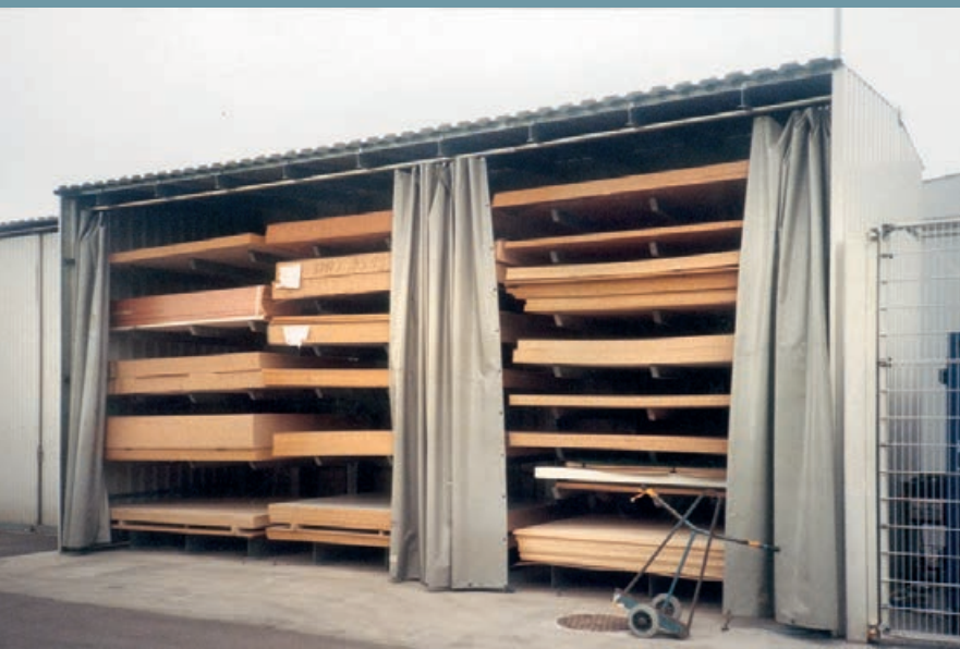
Individuální skladové řešení pro dřevěné desky: konzolové regály se střechou a stěnou a závěsy k ochraně před deštěm nebo sněhem
