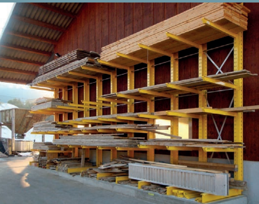
Skladování dlouhých výrobků pod přístřeškem tesařského provozu. Různé druhy a rozměry jsou skladovány přehledně v konzolovém regálu
