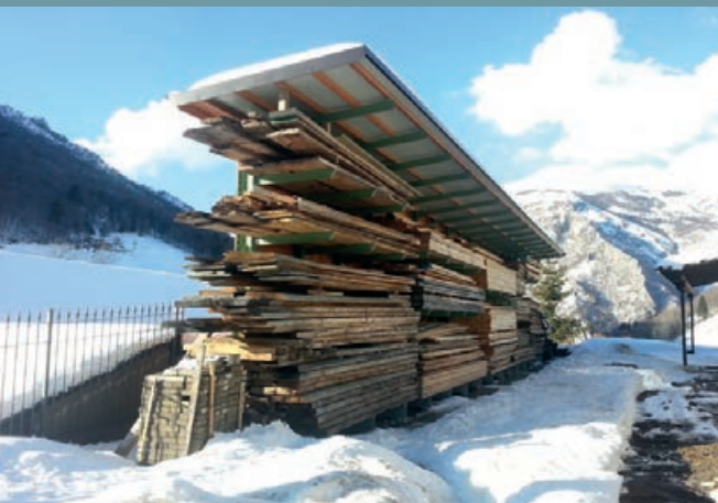
Konzolový regál se střechou v tesařském provozu. Optimální skladování ve venkovním prostoru
