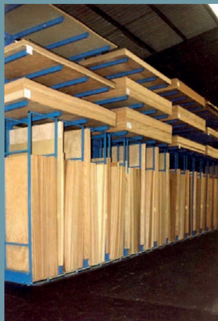
Kombinace konzolového regálu se zabudovaným regálem na dřevotřísku. Vysoká kompaktnost skladování na minimálním půdorysu
