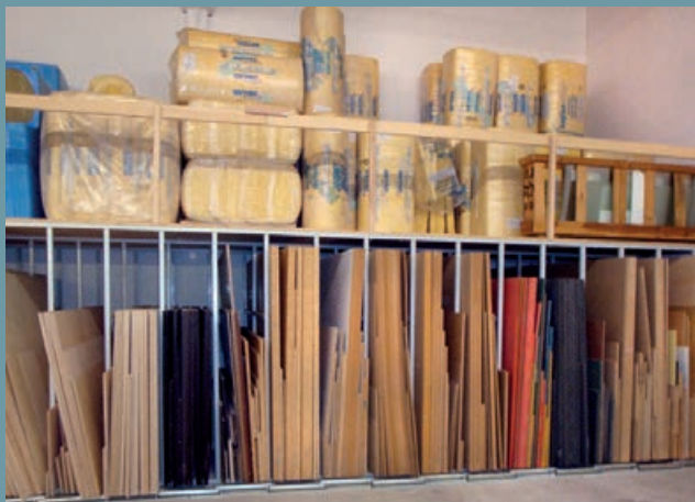
Uložení dřevotřískových desek nastojato s využitím horní strany jako doplňkové úložné roviny
