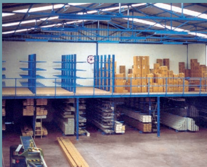
Skladová plošina jako mezipatro s konzolovými regály. Nahoře skladování v balících a částečně regálový systém.
