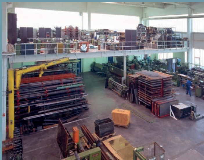
Dvojitá plocha v odvětví zpracování oceli. Pracoviště nahoře a dole. Zatížení 1 000 kg/m 2 .
